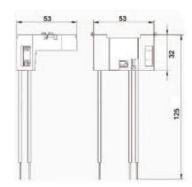
Überspannungsschutz als Ventilableiter (leckstromfrei)
